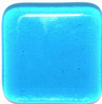
2 laagjes, totaal 6 mm dik Geen vormverlies, de hoekjes worden mooi afgerond
